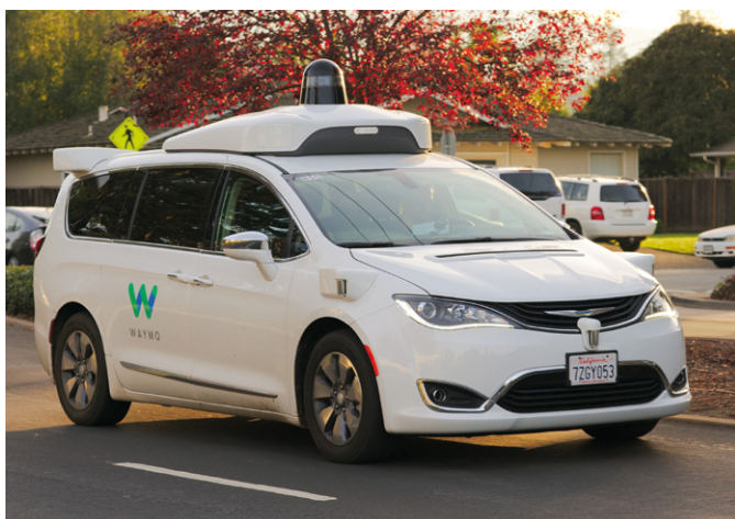
Markkinajohtaja Waymo aloitti robottiautojen koeajot jo 2009 ja kuljettajattomat tason 4 taksikydyt marraskuussa 2017. 360 asteen Lidar on kuvassa auton päällä ja muikin anturipatteristo on vaikuttava: 4 lisä-Lidaria, 5 radiotutkaa ja 9 kameraa.
